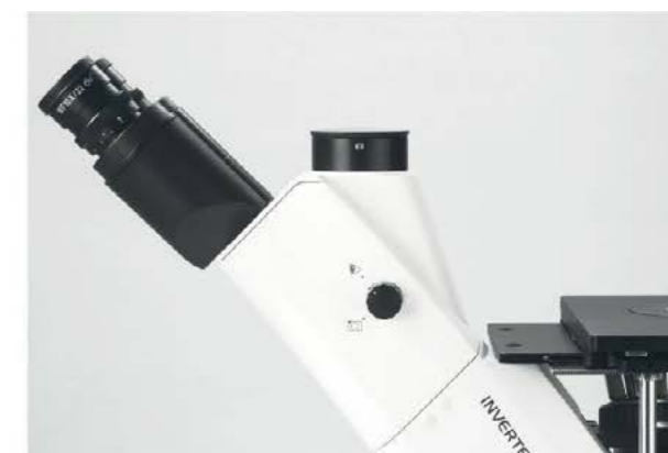
Cabeçote trinocular para utilização de câmera de alta resolução (já incluso)
