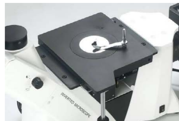
Mesa de trabalho de três camadas, para utilização de diversos tipos de amostras
