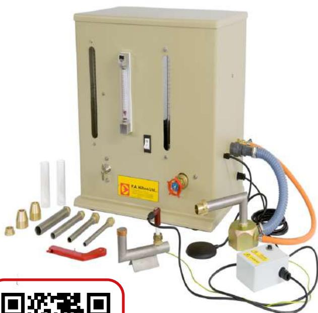
A unidade permite o controle e a medida da vazão de ar e do gás, através de dois medidores de vazão em série, que garantem que vários combustíveis gasosos típicos de queima lenta possam ser usados e medidos precisamente. Várias configurações da relação ar combustível permitem que as características de estabilidade da chama de gás possam ser examinadas, e os limites de estabilidade superior e inferior sejam desenhadas no diagrama de estabilidade.
