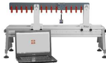
STS3 FORÇA DE CISALHAMENTO EM UMA VIGA
