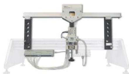
STS5 FLEXÃO EM UMA VIGA
