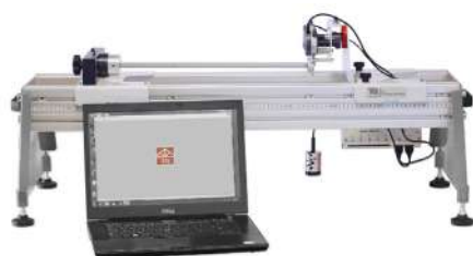
STS7 FLEXÃO ASSIMÉTRICA E CENTRO CISALHAMENTO
