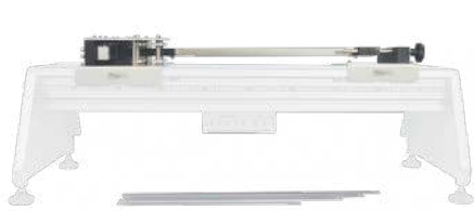
STS12 FLAMBAGEM DE ESTRUTURAS
