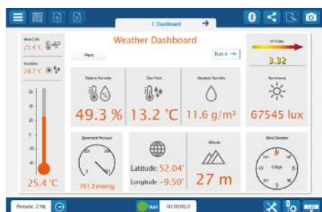
Painel de Controle para Monitorar Condições Ambientais
