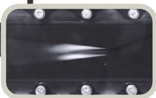
Cavitação dentro do Venturi
