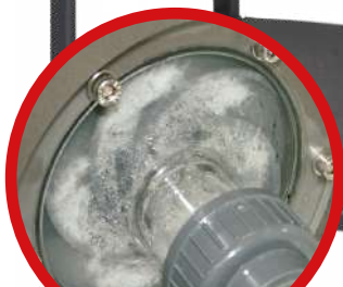
Demonstração da Cavitação dentro da bomba
