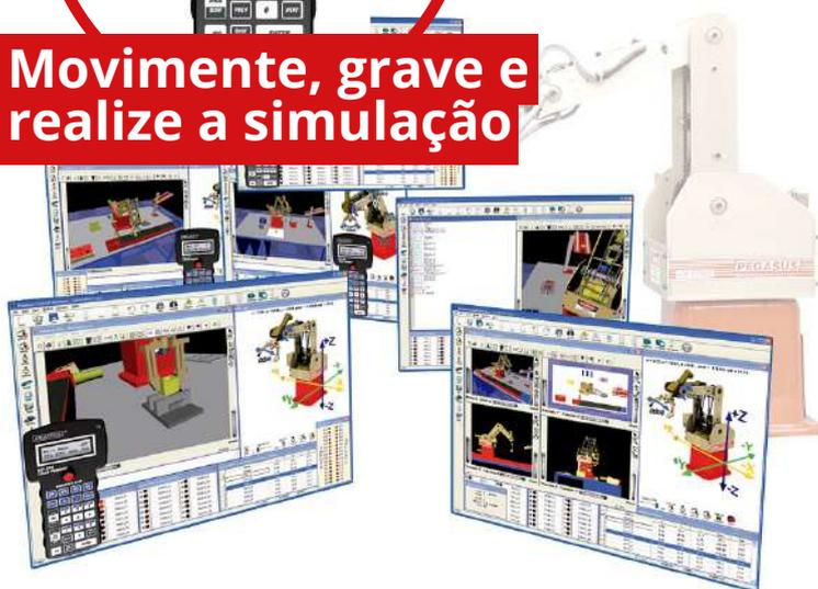
Simulação virtual do "Pegasus Servo Robô Articulado" em modo off-line, sem a necessidade de conectar o servo robô articulado para tal simulação.
