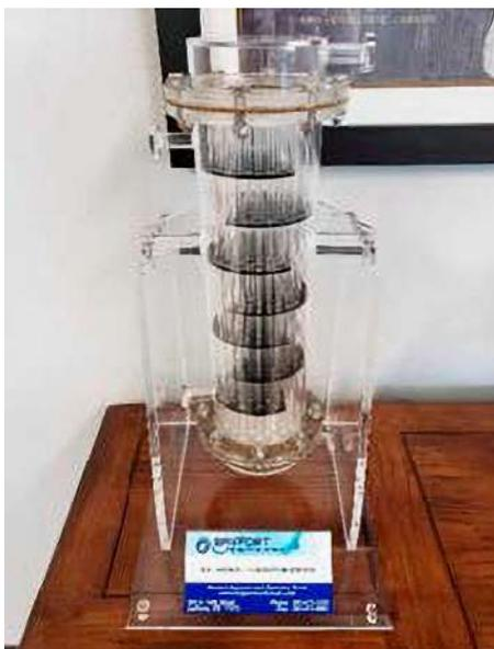
O modelo em acrílico apresenta as características operacionais de um termossifão vertical típico industrial. Este modelo de treinamento em acrílico resistente e transparente permite que o aluno desmonte o sistema, examine as peças componentes e entenda como a unidade é montada, incluindo o posicionamento da gaxeta. Os instrutores podem permitir que os alunos remontem a unidade para fins de treinamento.
