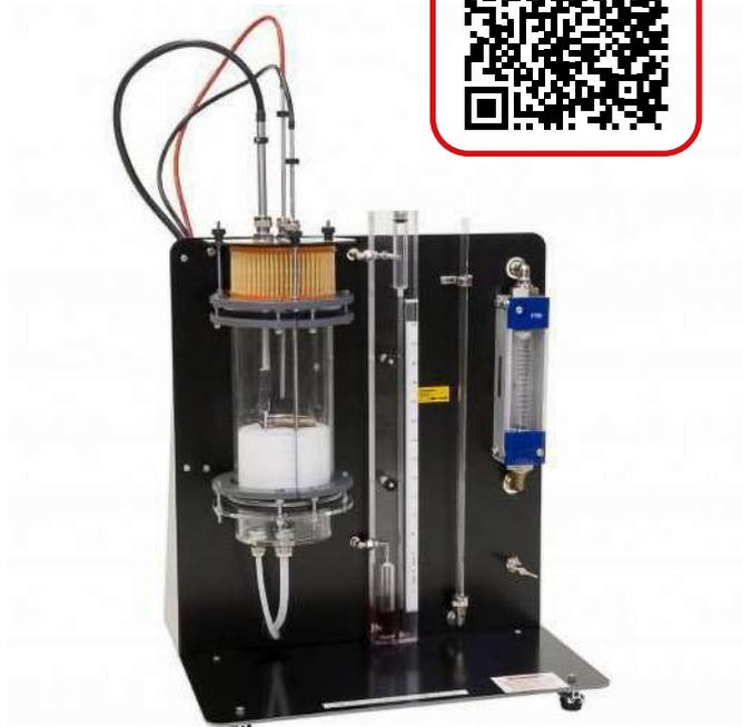
O sistema permite o aluno investigar o fluxo de gás através de um leito fixo e de leito fluidizado, e para medir a taxa de transferência de calor e os coeficientes para comparação com as taxas de transferência de calor no ar por convecção.
