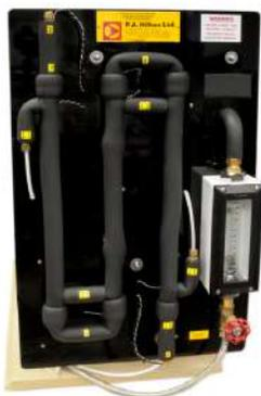
Trocador de calor de tubo concêntrico altamente avançado com água quente fluindo através do tubo central enquanto a água de resfriamento flui através do espaço anular.
