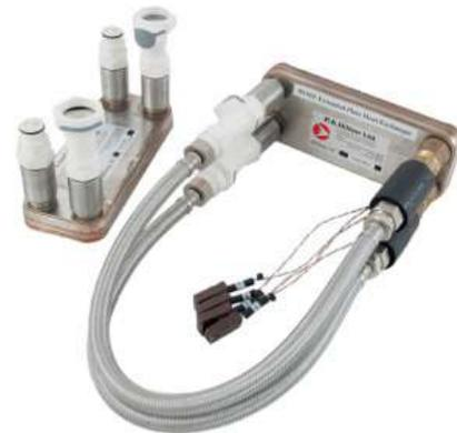
Uma versão estendida do trocador de calor de placas (H102B) com um total de 6 termopares. Em conjunto com o H102B, permite investigar os efeitos do aumento da área de transferência de calor.
