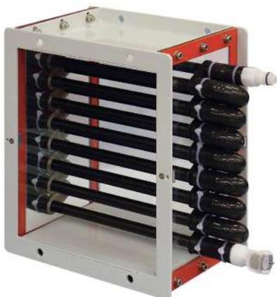
Trocador de Calor com 16 Tubos (metade área do trocador padrão)
