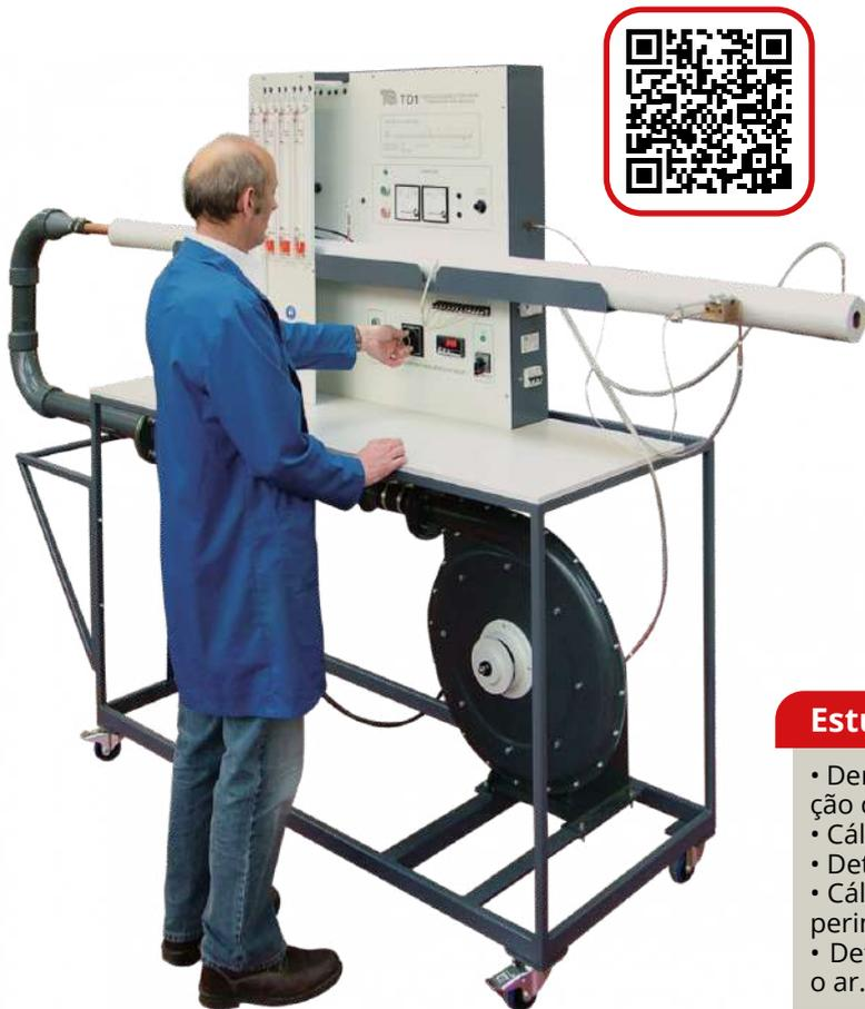
Um conhecimento básico da teoria da transferência de calor por convecção forçada é valioso em muitos campos da engenharia, especialmente no projeto de trocadores de calor. O aparelho de transferência de calor por convecção forçada da TecQuipment permite que os alunos examinem a teoria e as fórmulas associadas relacionadas à convecção forçada em tubos.
