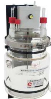
Recipiente transparente com revestimento externo em vidro, onde a água quente passa através dele ou de uma bobina de transferência de calor dentro do vaso para fornecer aquecimento externo ou interno.
