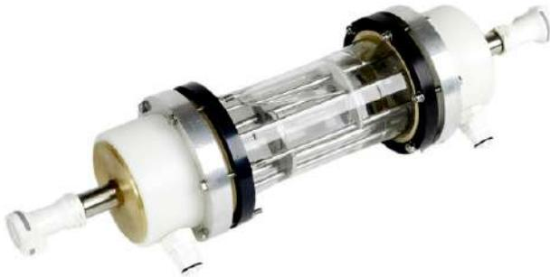
Quatro termopares medem as temperaturas de entrada e saída de fluido quente e frio. As conexões de engate rápido e auto-vedantes possibilitam praticidade na conexão ao H102 e conversão de fluxo paralelo para contra-corrente.
