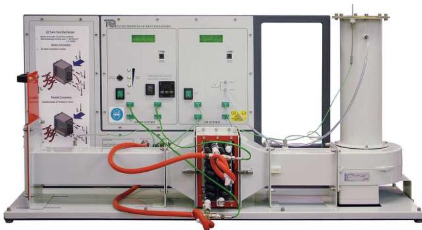
Sistema focado nas aplicações com aquecimento de ar e resfriamento de água. Para ser instalado em uma bancada, inclui um fornecimento de água quente, um duto de ar de resfriamento e todos os instrumentos necessários para os ensaios sobre trocadores de calor de fluxo cruzado. A troca de calor do conjunto produz bons resultados sem muitas alterações na temperatura de uma sala de aula ou laboratórios de dimensões razoáveis.
