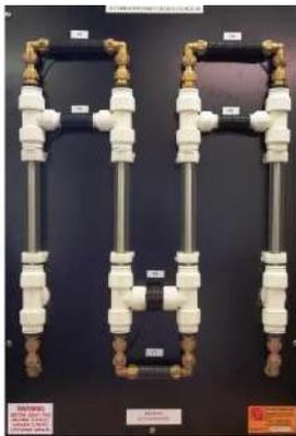
Uma versão estendida do Trocaador de Calor de Tubo Concêntrico (H102A) com 3 pares de pontos intermediários, fornecendo 10 termopares no total. Em conjunto com o H102A, isso permite investigar os efeitos do aumento da área de transferência de calor e a plotagem de mais pontos no gráfico de distribuição de temperatura.
