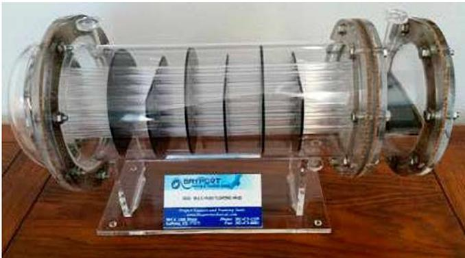
O modelo em acrílico apresenta os recursos operacionais de trocador de calor de cabeçote flutuante de múltiplas passagens. Este modelo de treinamento em acrílico resistente e transparente permite que o aluno desmonte o sistema, examine as peças componentes e entenda como a unidade é montada, incluindo o posicionamento da gaxeta. Os instrutores podem permitir que os alunos remontem a unidade para fins de treinamento.
